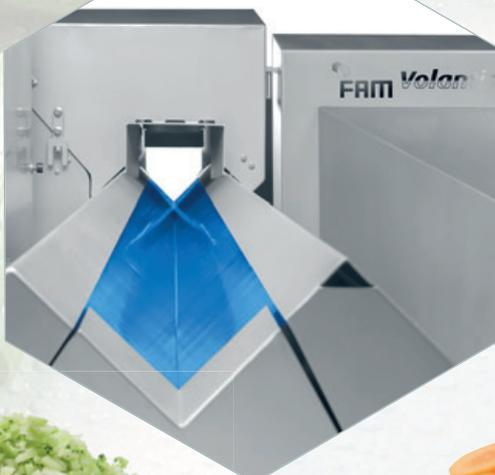
**Ein Beispiel:** Die **Volantis** ist die bevorzugte Schneidemaschine für das Querschneiden von grünen Bohnen, die ein saisonales Produkt sind. Die Volantis kann aber auch außerhalb der Saison für längliche Produkte wie Karotten, Stangensellerie, Zucchini u.a. verwendet werden, ist also ein ausgesprochen multifunktionales Schneidegerät.
