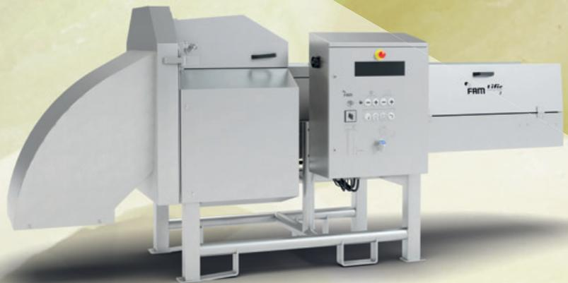
**V-Band-Schneider zum präzisen Querschneiden einer Vielzahl von langen und länglichen Produkten wie z. B. grüne Bohnen, Karotten, Zucchini**
