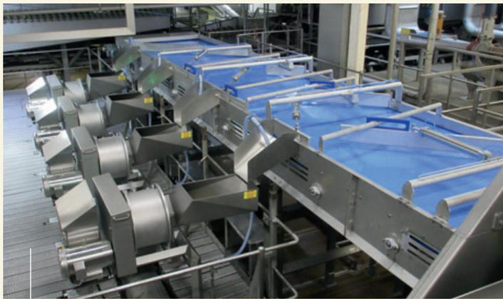
集成到大容量薯条生产线中的四台 Tridis 240P 机器。
