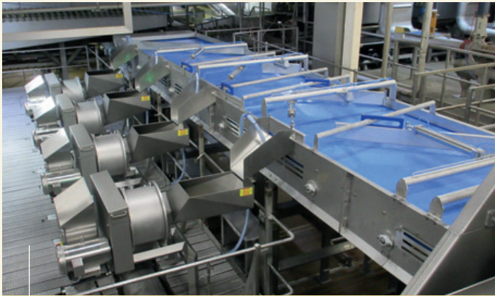
Vier Tridis 240P-Maschinen integriert in eine Pommes-Frites-Produktionslinie mit hoher Leistung.
