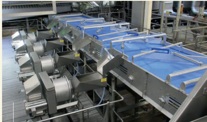
Машины Tridis 240P интегрированные в высокопроизводительную линию по производству картофеля фри.
