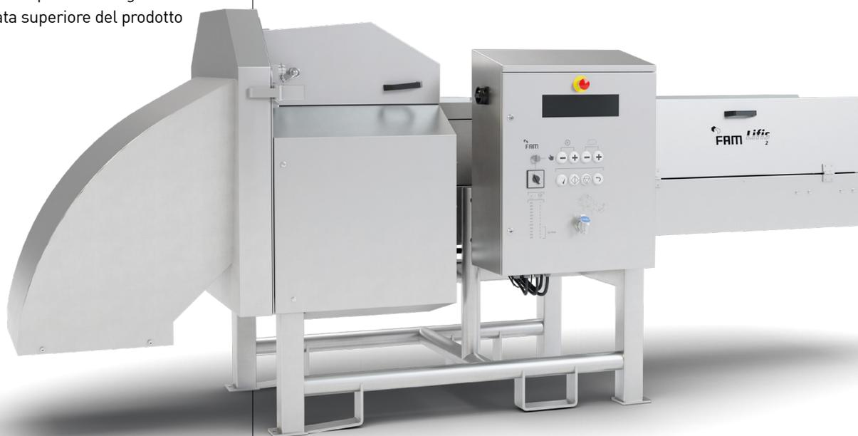
Lifis.2 può essere fornita con un gran numero di ruote di taglio intercambiabili che offrono la massima flessibilità nelle misure e nel tipo di taglio (fetta liscia, fetta ondulata, pezzi quadrati, etc.)
