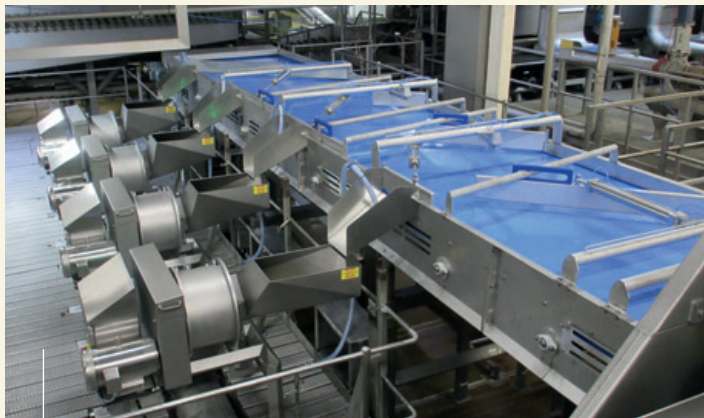
Cuatro máquinas Tridis 240P integradas en una línea de producción de patatas fritas de alta capacidad.
