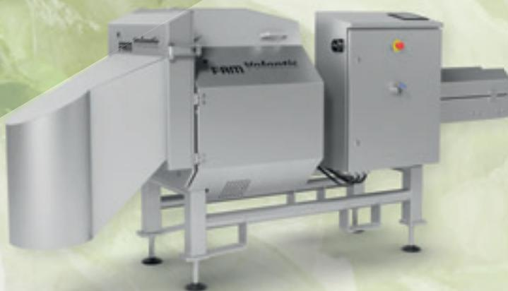
**V-Band-Schneider zum präzisen Querschneiden einer Vielzahl von langen / länglichen Produkten sowie komprimierbaren Blattsalatsorten und anderem Blattgemüse**
