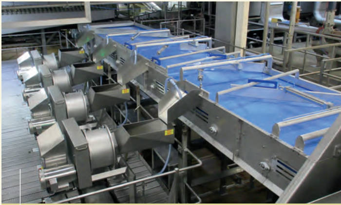
Quatre coupeuses Tridis 240P intégrées dans une ligne de production de frites grande capacité.
