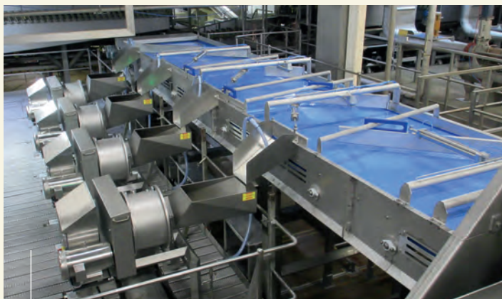
Vier Tridis 240P-machines geïntegreerd in een frietproductielijn met hoge capaciteit.
